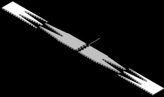
ERO Joint® HP es una solución de empalme mecánico patentada para correas de poliuretano. Se utiliza un pasador de bisagra con un único pasador de acero inoxidable para cerrar la correa.
