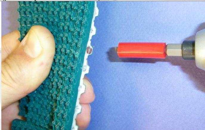
En fin de vissage, veillez à ce que la tête de vis ne dépasse pas de la courroie afin qu'elle ne frotte pas sur les poulies.
